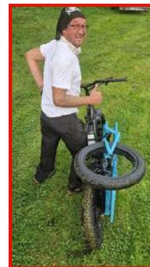
Ce véhicule d'assistance offrira une conduite adaptable, soit en position assise sur la plateforme avec rampe (pour une utilisation autonome en fauteuil roulant), soit en position debout.
